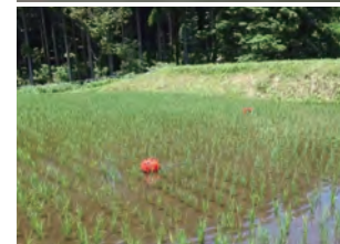
図1 実証に用いた球体型除草ロボット（上：本体、下：実験の様子（阿蘇水掛の棚田））
