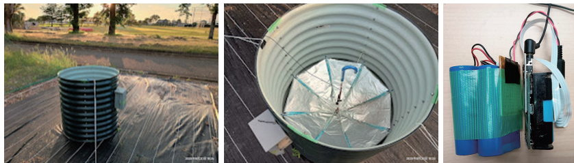
図 左から：遮音ブランター、集音パラボラ、録音機
