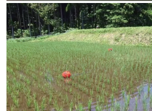
図1 実証に用いた球体型除草ロボット（上：本体、下：実験の様子（阿蘇水掛の棚田））
