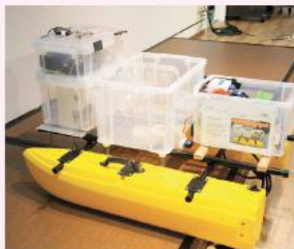
自律航行できる水上ドローンを開発。一台で水底の撮影と給餌を実現します
