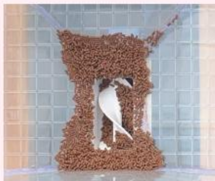
ケースに餌を入れると、モーターの回転により水中に散布。給餌量の調整も可能
