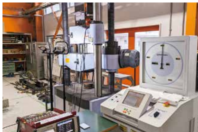
1000kN万能試験機によるケーブル引張実験 Cable tensile test with 1000kN universal testing machine
