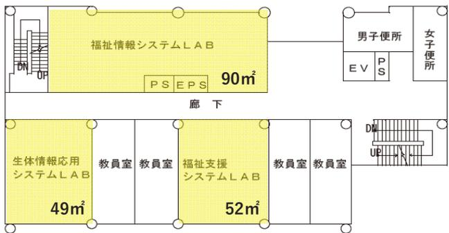
5号棟2階平面図 S = 1 / 400
