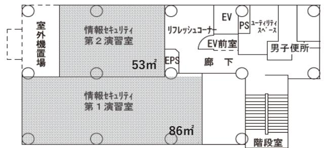
6号棟4階 平面図S=1/400
