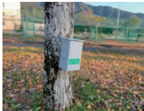
図 運動場の片隅に設置したフライトコール観測装置 (録音には密閉したDM-750と外付けマイクを利用)
