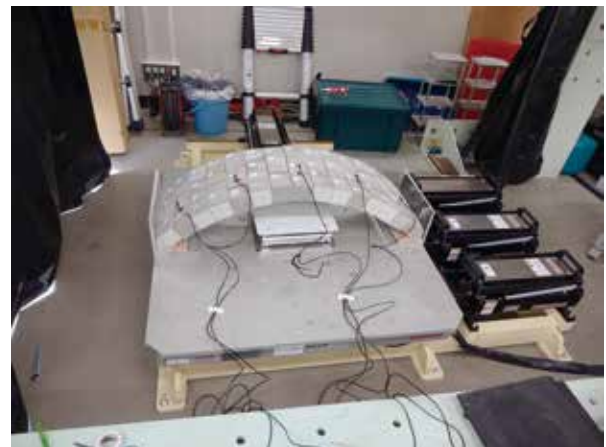
水平2方向振動台による石橋実験 Direction shaking test of stone bridge
