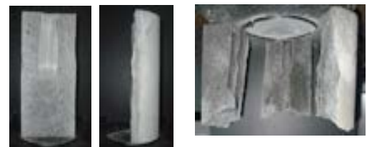
縦方向への亀裂制御
