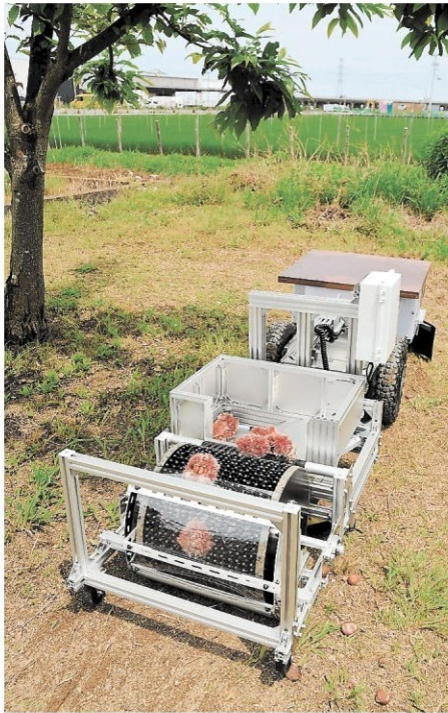
末松電子製作所で試作した自律走行型クiri収穫機。電動けん引機（奥）に連結した収穫機（手前）が回転ブラシでいがぐりや実を拾い集める
