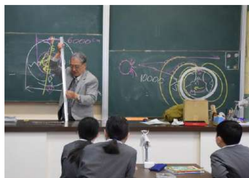
アルミレールの上をゆっくり滑り落ちるネオジム磁石(うず電流)
