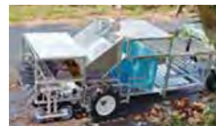
図2：ゴム板回転式栗収穫ロボット
