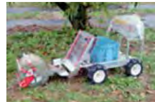
図1：ブラシ式栗収穫ロボット
