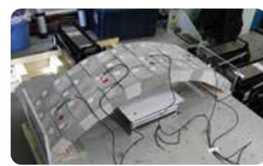
振動台による振動実験
