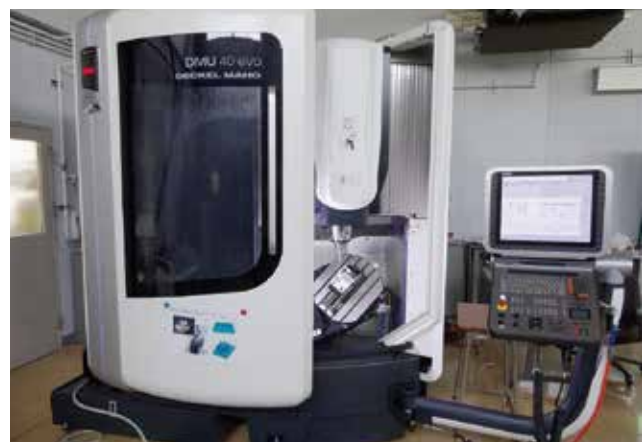
5軸汎用マシニングセンタ High-end 5-axes simultaneous machining
