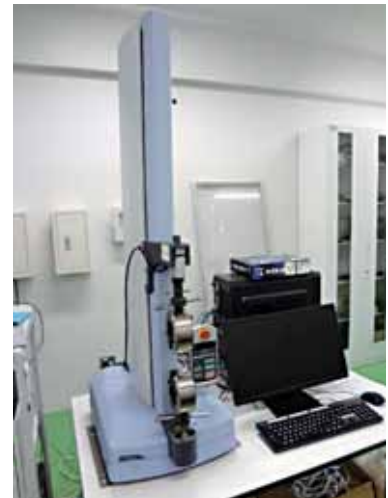
図3： 島津小型卓上試験ユニット EZ-LX 5 kN
