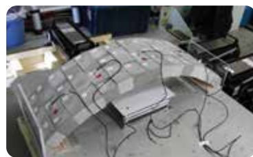
振動台による振動実験
