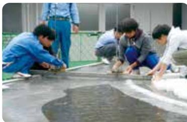
球磨川模型の水位計測
