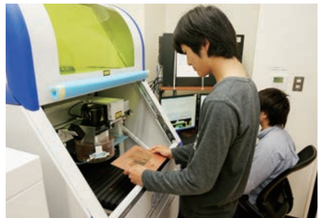
レーザー加工機による回路基板の試作 Prototyping PCBs using laser processing machine
