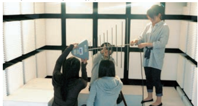
電波暗室でのアンテナの実験 Experiment of horizontal pattern of antenna in radio anechoic chamber
