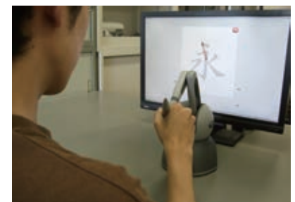
書字アシストシステムの開発 A virtual handwriting system with assistive forces
