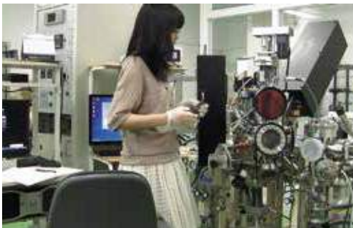
PLD 装置を使った特別研究 (超伝導実験) Experimental study on superconductors used the pulsed laser deposition
