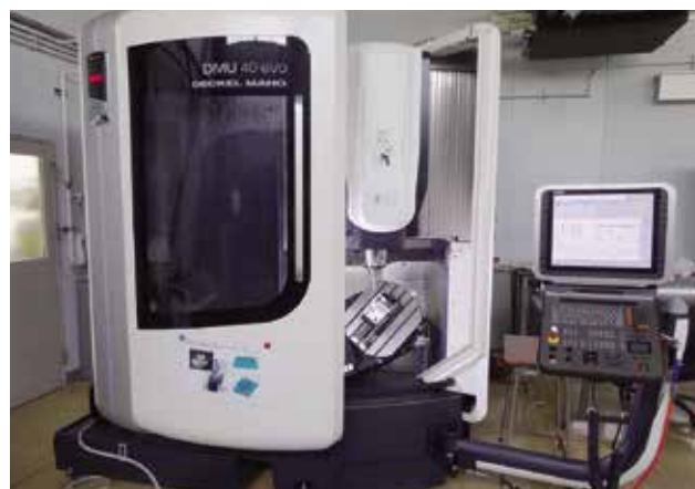
5軸汎用マシニングセンタ High-end 5-axes simultaneous machining
