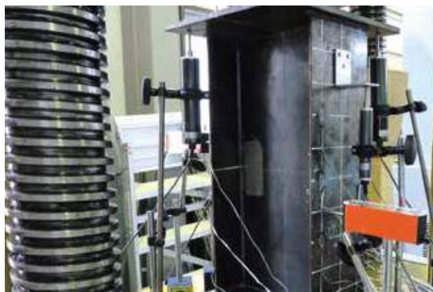
1000kN万能試験機による耐荷力実験 Structural experiment with 1000kN universal testing machine
