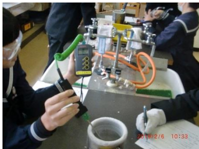
液体窒素の温度測定
