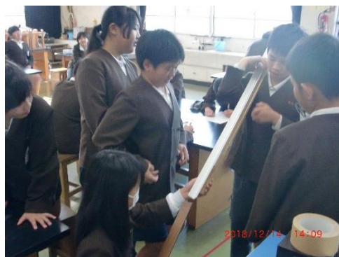
アルミの斜面の上で磁石を転がして下に見える銅板もつなげて違いを見る
