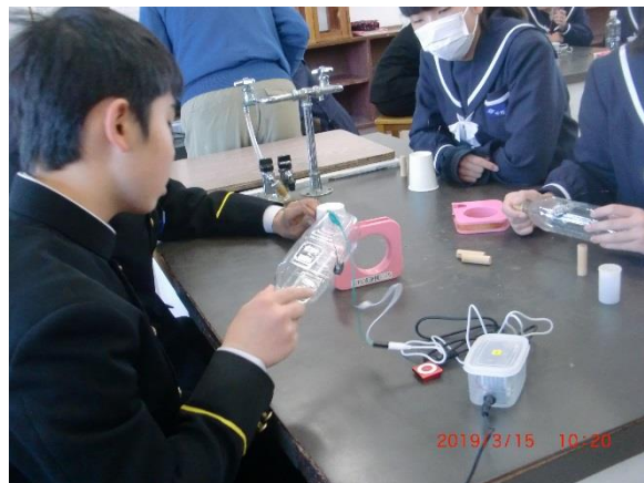
コイルと磁石を重ねてペットボトルの外側にはりつけてスピーカーを作る。
