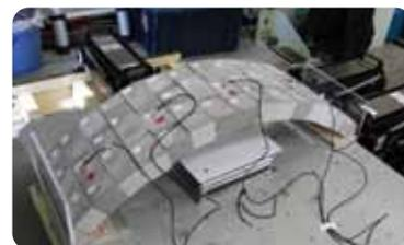
振動台による振動実験
