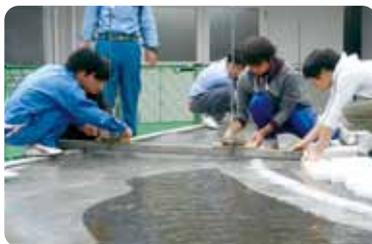
球磨川模型の水位計測
