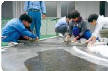
球磨川模型の水位計測
