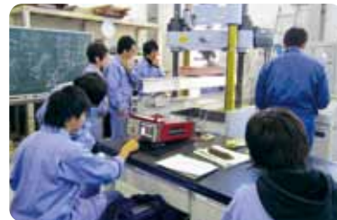
鉄筋コンクリート梁の曲げ破壊試験
