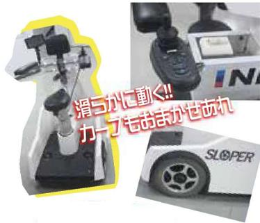
障害物はセンサーで感知して迂回する。両輪に回転数を測定するセンサーをつけ、移動距離を測ることもでき、カーブや幅の狭いスローパーもスムーズに上り下りできる。
