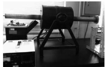
図1 賦活のための管状電気炉
