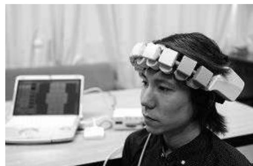
図 2 携帯型 NIRS 装置の装着の様子
