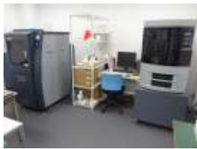
アクリル樹脂材 3D プリンタと ABS 樹脂材 3D プリンタ
