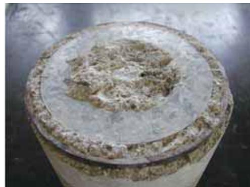
写真1 動的破碎された柱状部材の破断面
