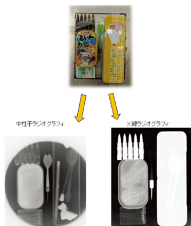
図1 中性子ラジオグラフィと X 線ラジオグラフィの比較
