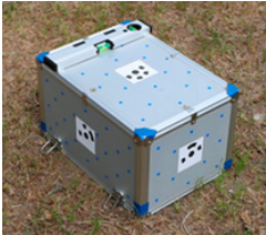
図6 水平器によるケースのレベル出し
