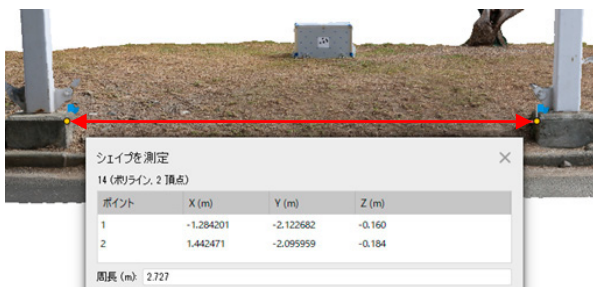
図 19 鉄柱の土台のコンクリート間の距離
