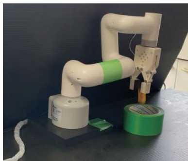
図2 mycobot 280 Pi によるピッキング制御
