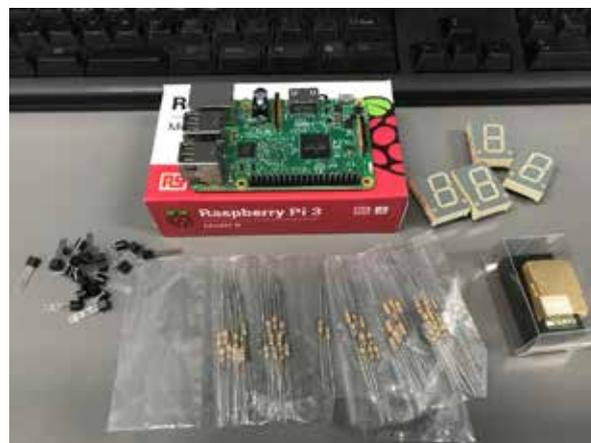
図3 CO<sub>2</sub>モニターで使用した主なパーツ
