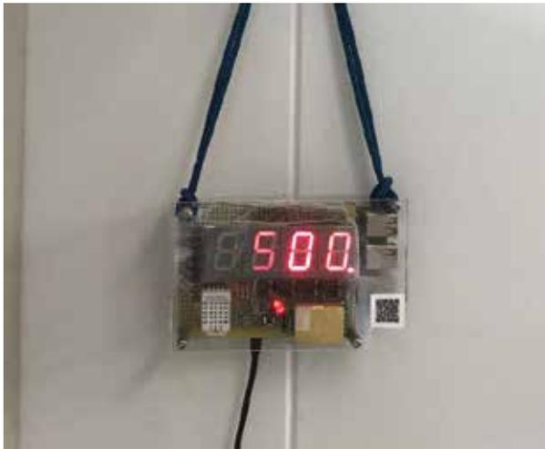
図 8 教室に設置した CO<sub>2</sub> モニター装置の様子
