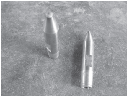
図 2 電極チップ（先端直径 4 mm）
