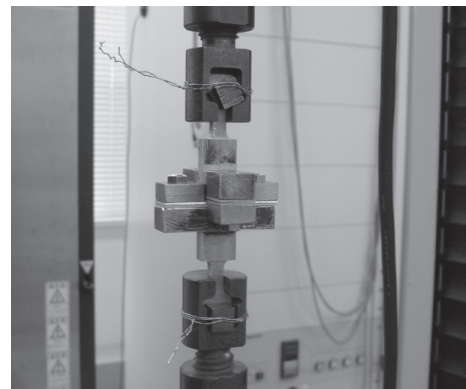
図 5 十字引張試験の様子
