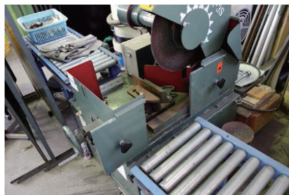
図 4 HDD の切断に用いる高速切断機 (Fig. 4 High speed cutting machine used for HDD cutting)
