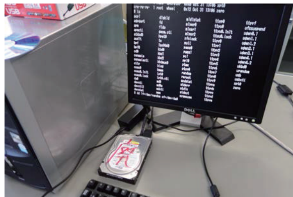
図 2 dd による物理フォーマット中の様子 (Fig. 2 Satate in physical format by dd)
