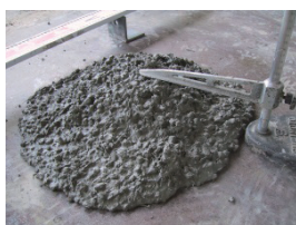
写真6 PVA1スランプ状況
