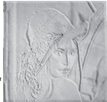
図 13. マシニングセンタによるレリーフ加工結果
