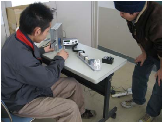
図4 「工業基礎計測」での放射線計測実験の様子（ \gamma 線の吸収係数測定）
