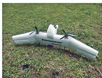
図3：マルチコプターから飛行機になる垂直離着陸機
