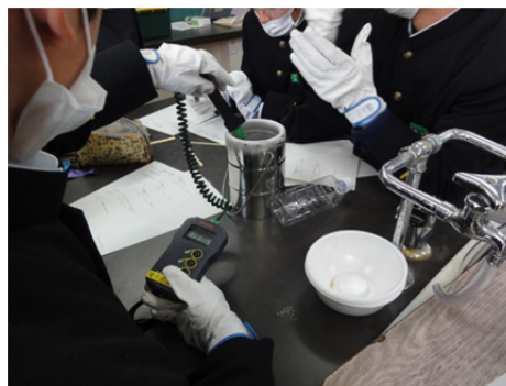
液体窒素の温度測定 表示は -193.6^{\circ}\text{C}
