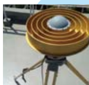
GPS・GNSS測量
