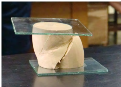
圧力を加えて押しつぶされた粘土
