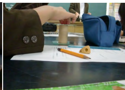
粘土の供試体に力を加える
