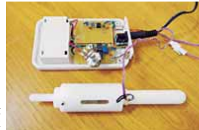
図4: 開発を担当した、振動覚検査装置 試作器と振動制御装置
