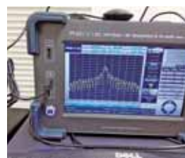
写真4:RFレコーダ装置
