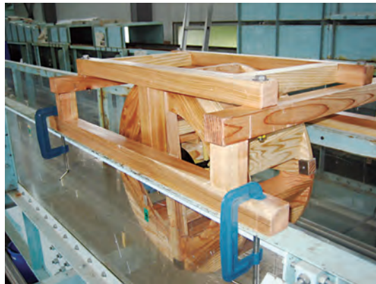
図4:水理実験水路上の水車
