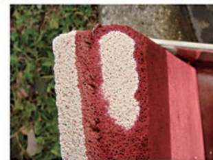
内部の浸透状況
